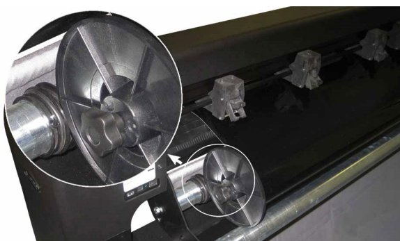
FIG 1-19 POSICIÓN DE UN TAPÓN DE ALINEAMIENTO EN UN PLOTTER DE CORTE
