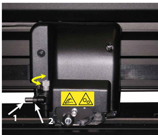
FIG 1-23 EXTRACCIÓN DEL PORTACUCHILLAS DE LA PINZA
