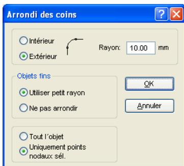
Fig. 6.3-3: Fenêtre d'arrondi des points nodaux
